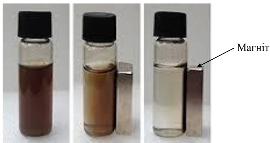
Рис. 3.32. Зображення процесу осадження функціоналізованих магнітних мікрочастинок у магнітному полі.
