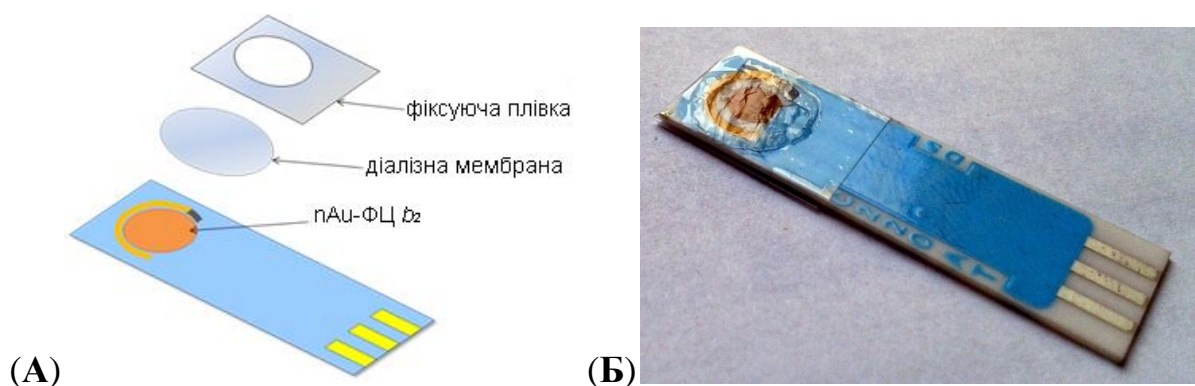
Рис. 3.97. Схема формування (А) та загальний вигляд прототипу L-лактат-селективного біоелектроду для проведення неінвазивного сенсорного аналізу вмісту лактату (Б).
