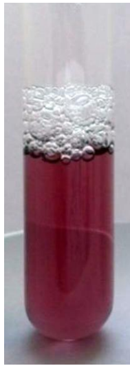
Рис. 3.68. Загальний вигляд (зліва) та спектр світлопоглинання (справа) отриманих золотих наночастинок.
